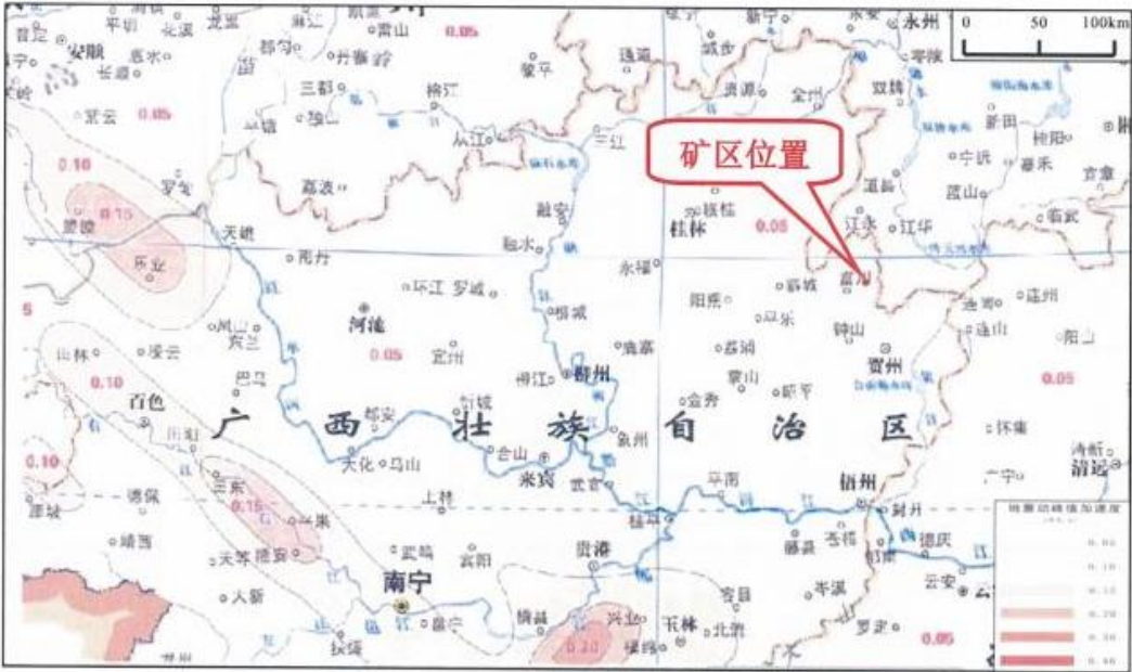
图 2-6 地震动峰值加速度区划图 (资料来源: 中国地震动参数区划图 (GB18306-2015))
